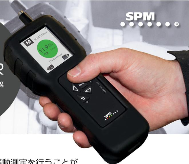
マシンバイブチェッカーは周波数範囲 10~1000Hz の振動測定を行うことができる小型の計測器です。測定結果は、振動の厳しさを直感的で明確に表す ISO 規格に基づき、瞬時に自動的に評価されます。また、FFT スペクトルを使ってパターン認証を簡単に行うことができ、振動レベルの傾向管理や後のフォローアップを行うために測定結果を保存することもできます。外付けトランスデューサを使い、わかりやすい記号のガイドに沿ってシンプルな操作を行うだけで、振動に関する問題を簡単便利に検知する理想的なツールです。
